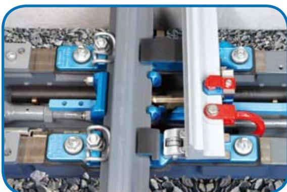
A differenza del classico fermascambio a morsetto, questo tipo di fermascambio è concepito in maniera tale da poter assorbire, senza alcun problema, gli scorrimenti longitudinali dell'ago, dovuti ad escursioni termiche, nel campo tra +30mm e -30 mm. I collegamenti a vite, rilevanti per la sicurezza, sono assicurati in modo doppio contro lo svitamento e, pertanto, non possono allentarsi autonomamente neanche in presenza di elevate vibrazioni (presenti, ad esempio, nelle linee ad Alta Velocità).
