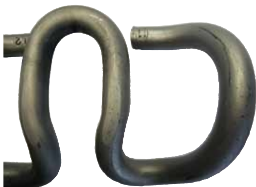
Bild 1: NiroTec® -Beschichtung nach Beschuss
