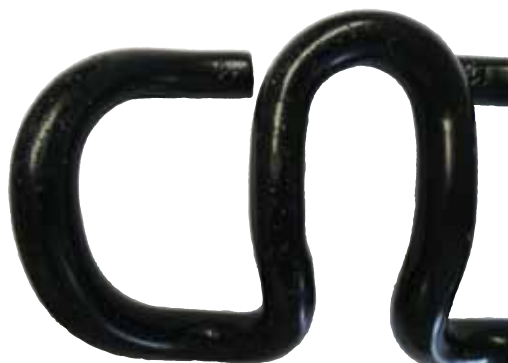
Bild 2: KTL-Beschichtung nach Beschuss
