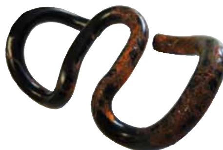
Bild 4: KTL-Beschichtung nach 480h
