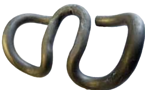
Bild 3: NiroTec® -Beschichtung nach 480 h
